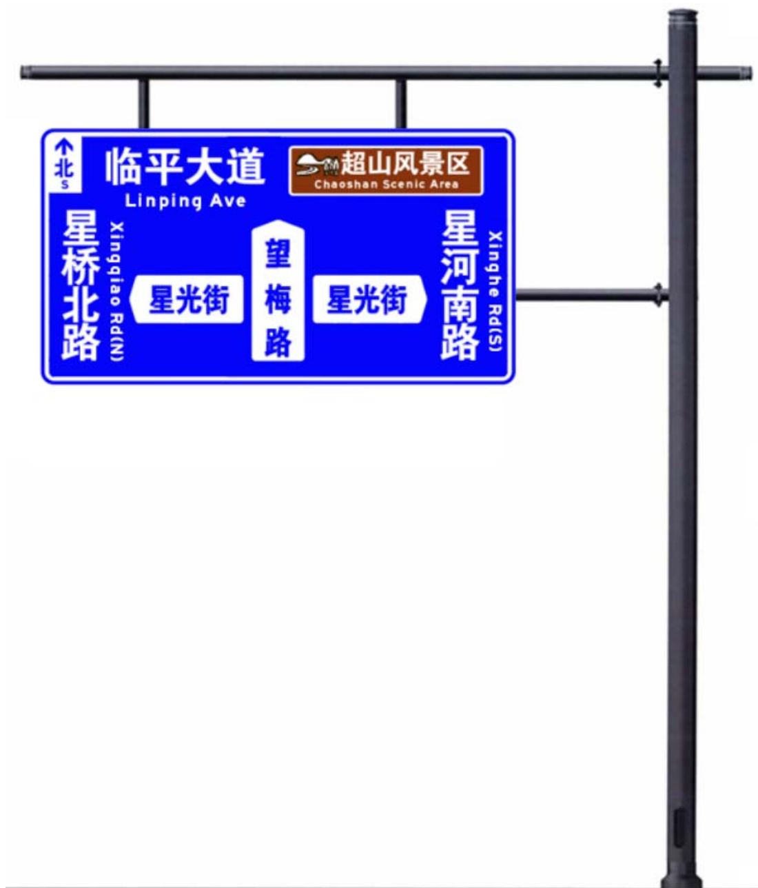
图B-1 悬臂式指路标志框架结构样式
