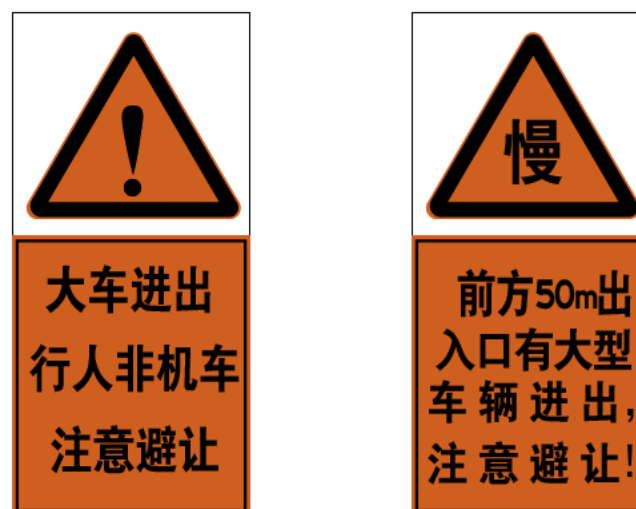
图 4.11-7 施工开口标志
